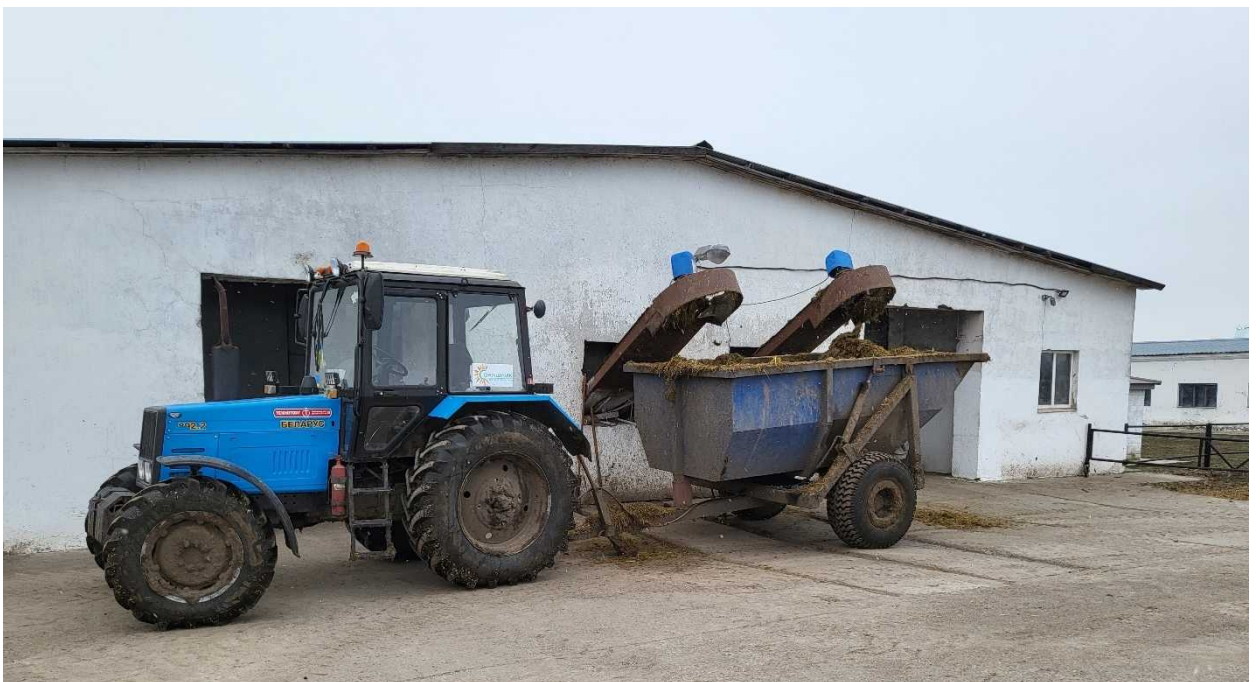
Рис. 3.5. Вивантаження гною похилим транспортером
