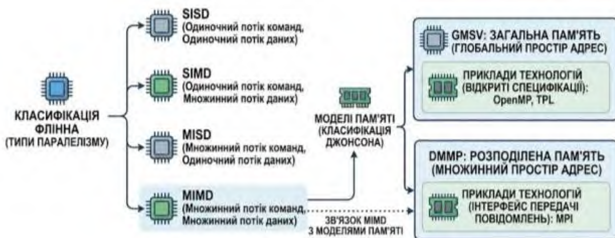
Рисунок 1.1 – Класифікація Флінна та Джонсона: зв'язок між типами паралелізму та моделями пам'яті
