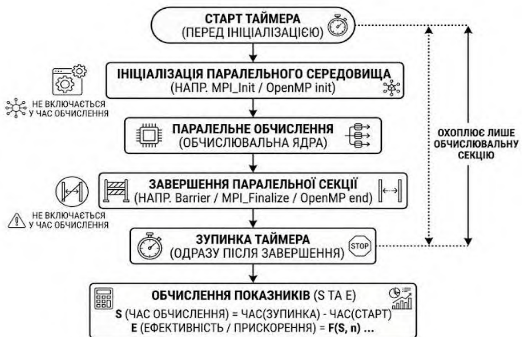
Рисунок 2.1 – Схема вимірювання часу виконання паралельної програми
