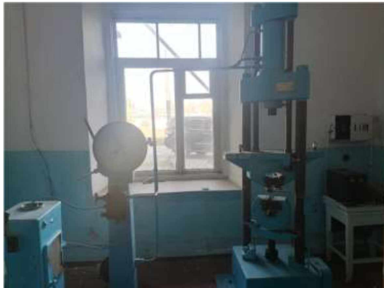
Рисунок 2.11 – Універсальна випробувальна машина ИМЧ-30
