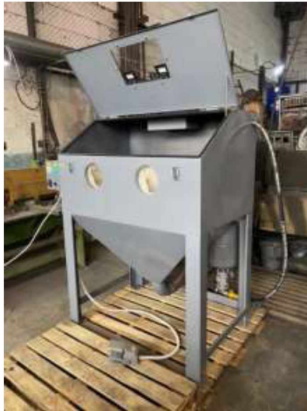
Рисунок 2.4 – Піскоструминна камера КСВ (витяжна система знята)
