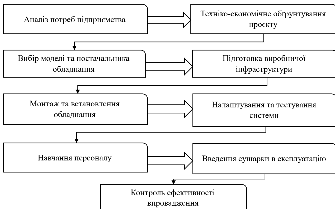
Рис. 3.3. Рекомендовані етапи впровадження зерносушарки типу «Sukup Mixed-Flow» на підприємстві, 2027-2029 рр.
