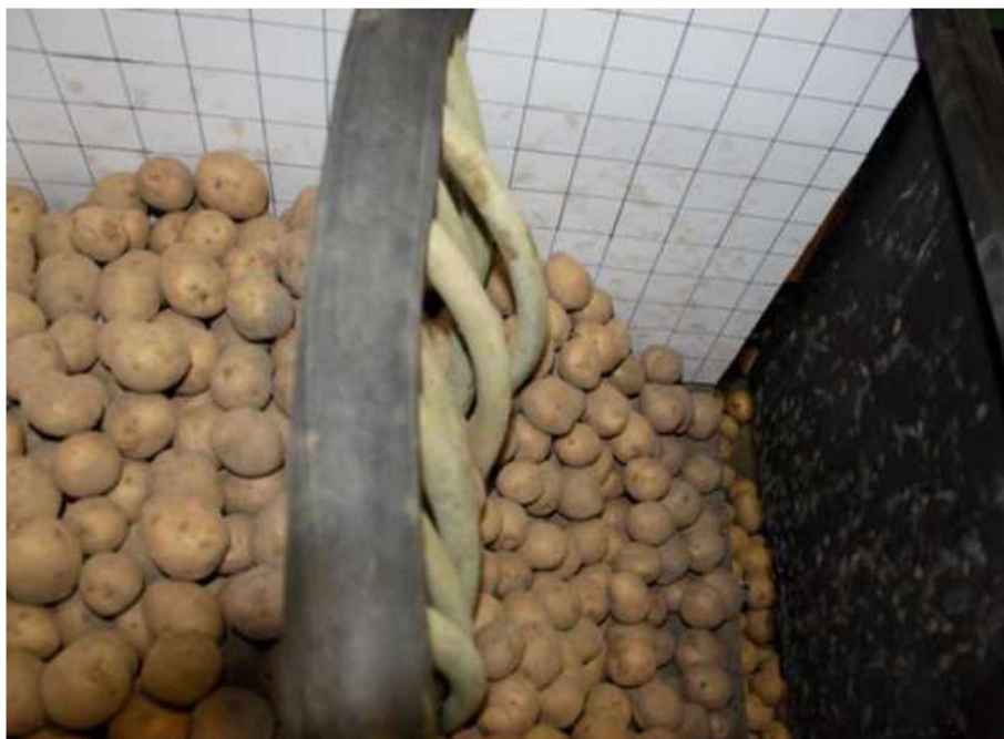
Рисунок 3.3 – Загальний вид контейнера з картоплею обладнаного еластичною перегородкою під час розвантаження
