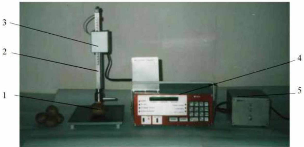
Рисунок 3.1 – Прилад ПРГ-401: 1 – картопля, 2 – вимірювальний щуп, 3 – вимірювальний блок, 4 – блок керування, 5 – блок живлення
