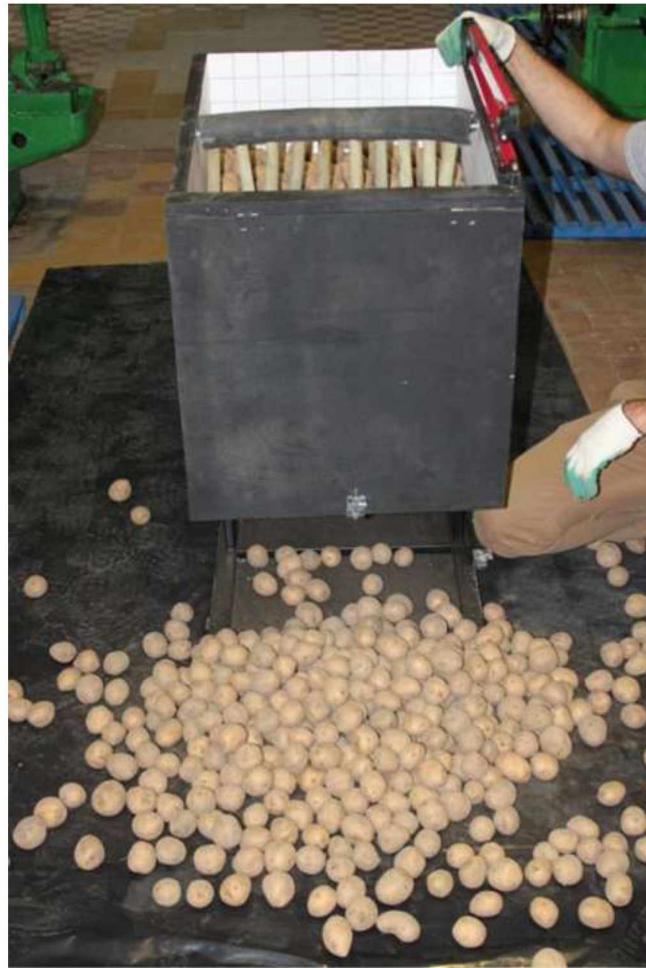
Рисунок 3.4 – Загальний вид контейнера, обладнаного еластичною перегородкою при дослідженні гуркоту бульб картоплі
