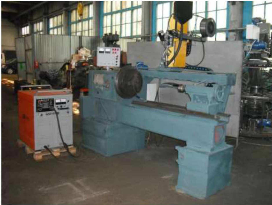
Рисунок 2.1 – Загальний вид лабораторної установки для наплавлення
