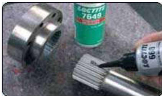
Рисунок 1.4 - Відновлення шліцьового з'єднання полімером.
