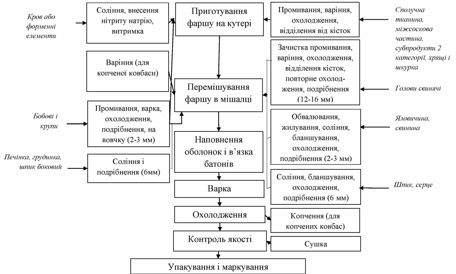
Рис. 3.3. Технологічна схема виробництва кров'яних ковбас
