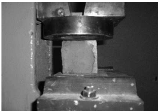
Рис. 3. Випробування зразків ґрунтоцементу на стиск
