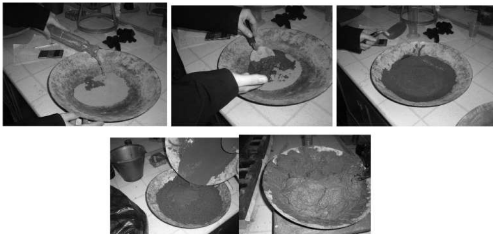
Рис. 2. Виготовлення суміші для дослідних зразків
