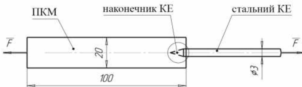
Рисунок 2.4 – Схема комбінованого з'єднання «сталь-ПКМ»
