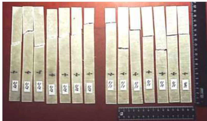
Рисунок 2.2 – Представники зразків з ПКМ
