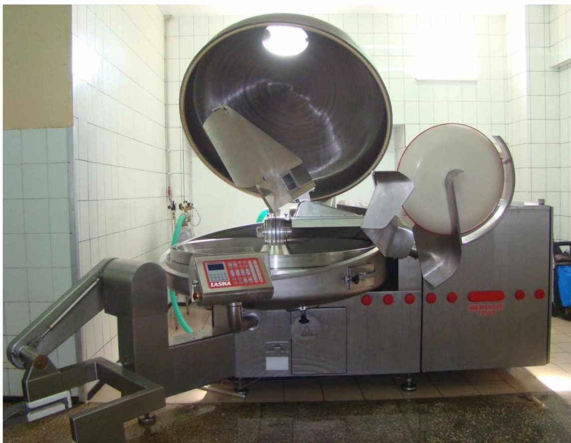
Рисунок 3.1. Приготування фаршу для сирокочених ковбас на кутері
