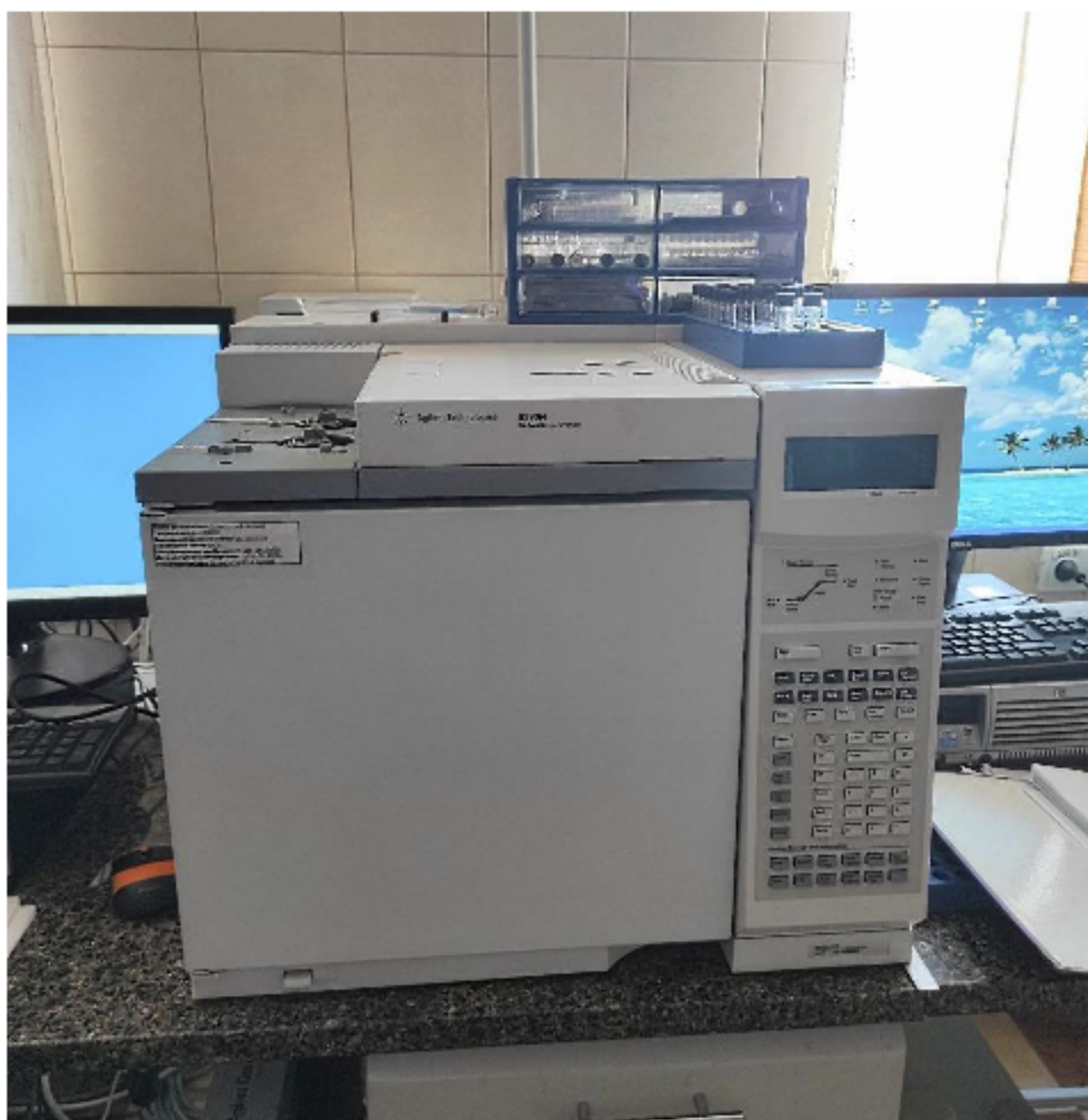
Рис.2.3.3.1. Візуальна демонстрація газового хроматографу моделі Agilent 689N
