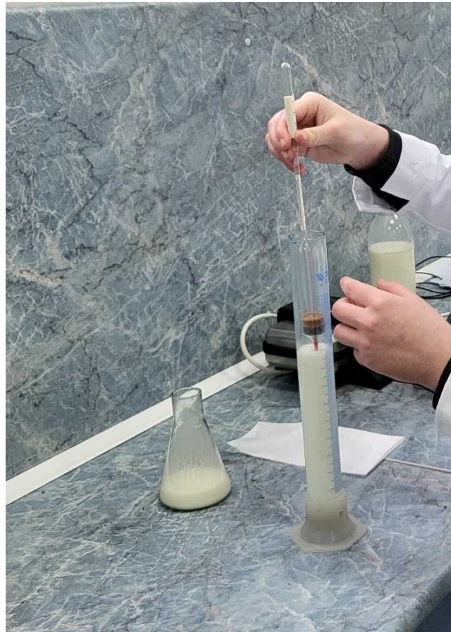
Рис. 3.2. Визначення густини молока
