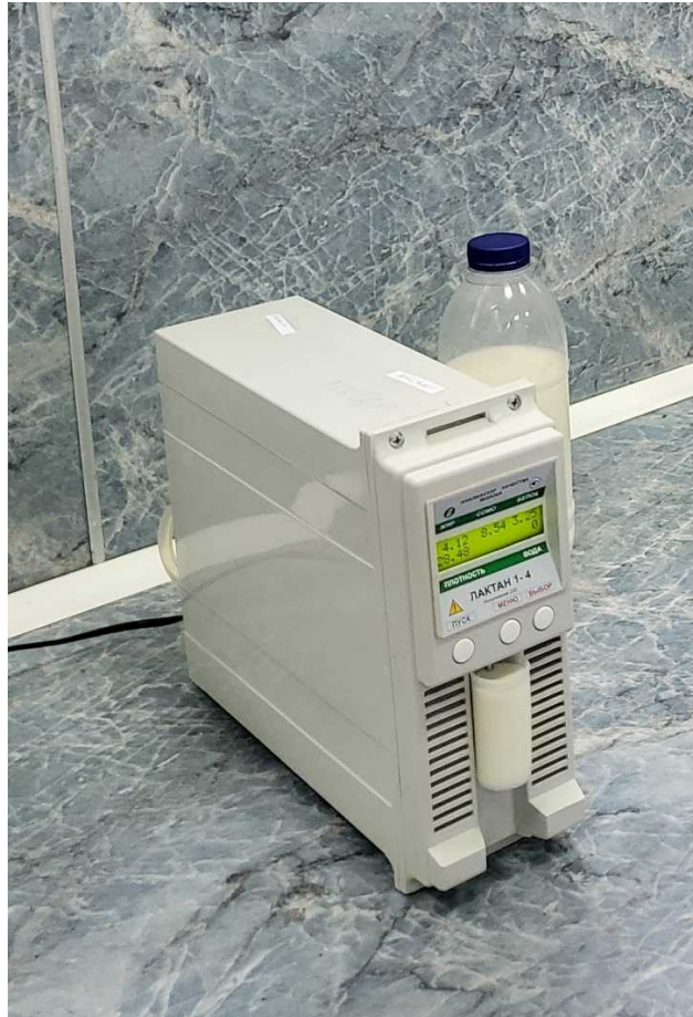
Рис. 3.1. Дослідження молока на аналізаторі «Лактан 1-4»
