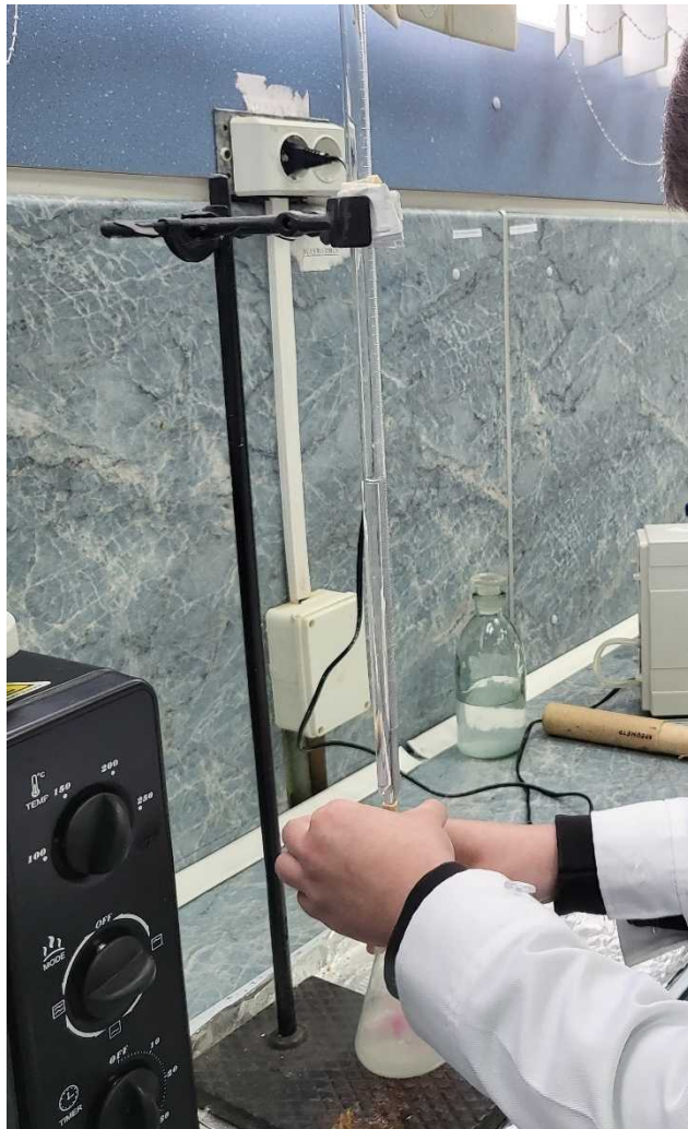
Рис. 3.3. Визначення титрованої кислотності молока
