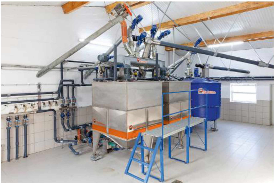
Рис. 3.11. Система годівлі Big Dutchman HydroMixpro
