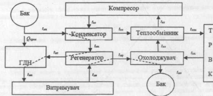
Рис. 1. Схема технологічної взаємодії теплових апаратів пастеризаційної установки з використанням теплового насоса
