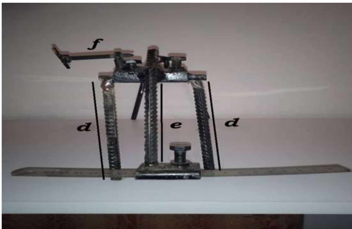
Рис. 1. Прилад хофмір . a, d – ніжки (14 см.); b – підставка до тримача селфі-палки (5 см.); c – тримач селфі-палки; e – тримач лінійки; f – гвинтовий фіксатор селфі-палки
