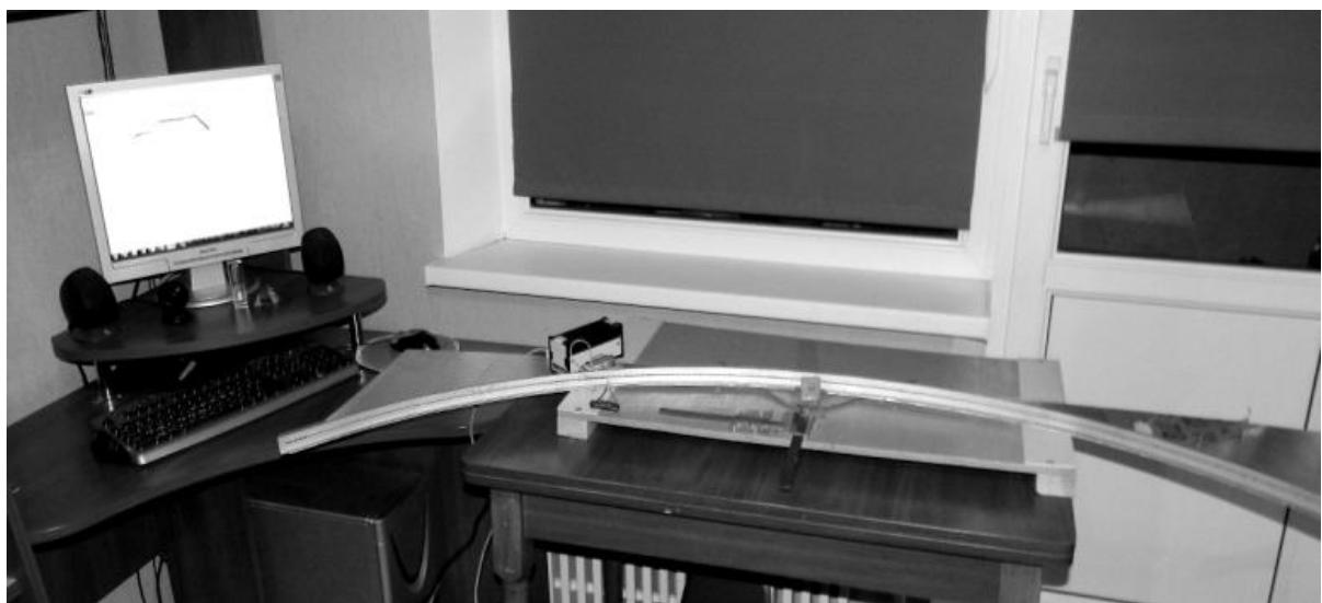
Рис. 4.5. Компьютеризированная система измерения углового отклонения рулевых поверхностей летательного аппарата
