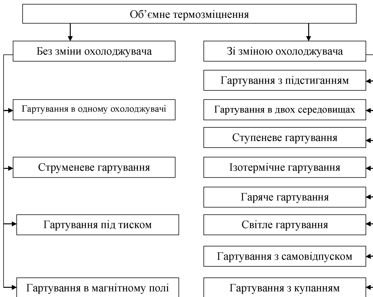
Рисунок 1.2 – Способи об'ємного гартування в залежності від умов охолодження
