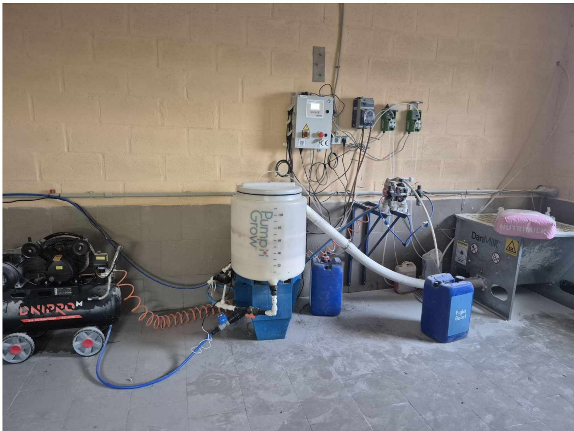
Рис. 18. Система для автоматичного приготування та подачі молоком поросят
