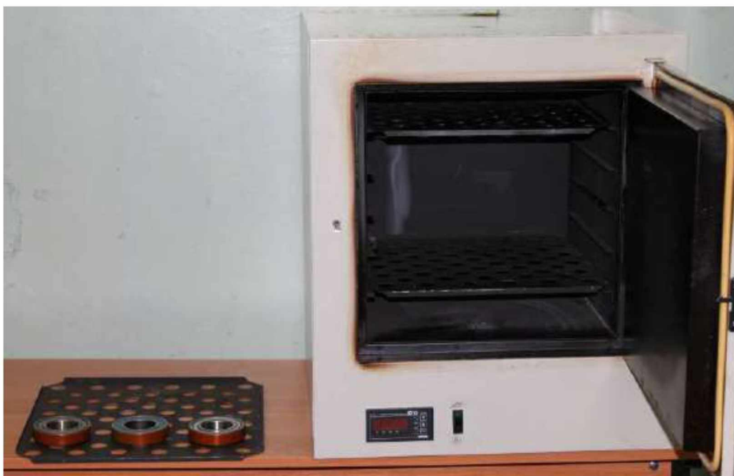
Рисунок 2.4 - Сушильна шафа і підшипники з полімерним покриттям після термічної обробки
