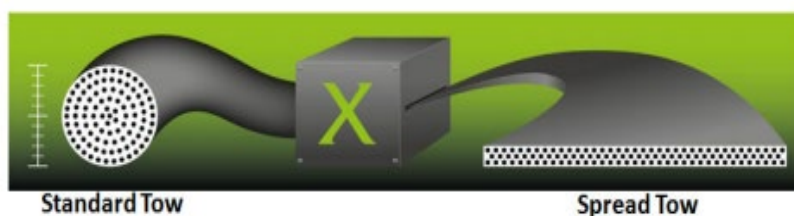
Рис. 2. Схематичне зображення волокна до та після розпушування (спреду)
