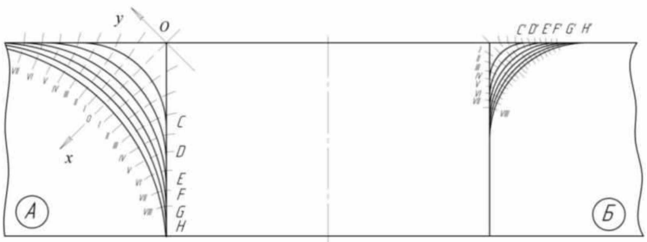
Рисунок 2.9 – розрахункова схема щодо побудови «зношувальної сітки» по осьовому перерізу у серійного виготовленому сепарувальному отворі решет
