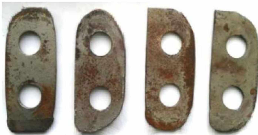
Рисунок 1.11– Втрата форми і маси молотків дробарки при спрацюванні
