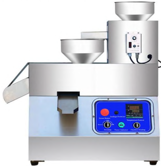
Рис. 3.3. Шнековий олієпрес Oil Extractor OP-50-8 з автоматичним дозатором прес для холодного віджиму
