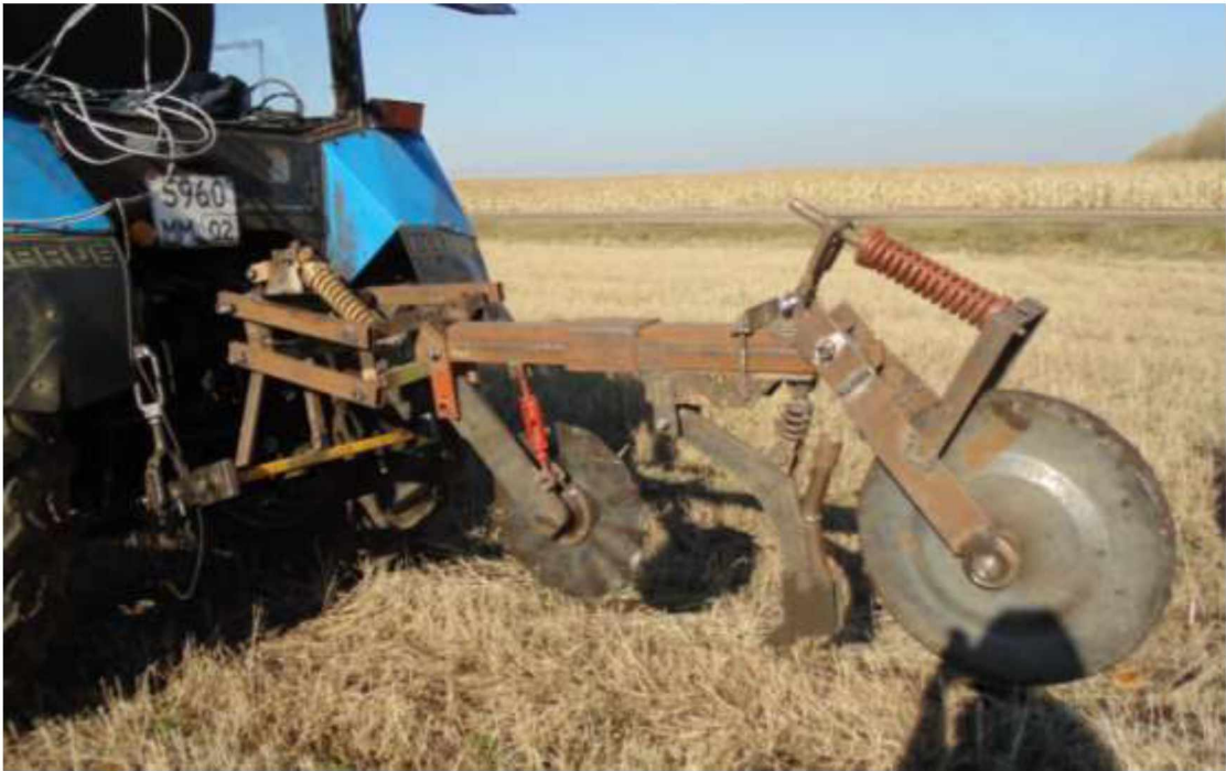
Рисунок 2.2 – Експериментальна установка для дослідження посівної секції в польових умовах
