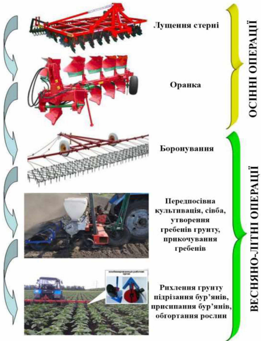
Рисунок 3.3 – Операції пропонованої технології гребеневого обробітку просапних культур
