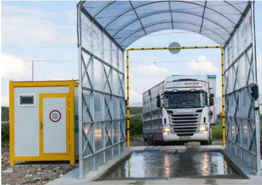
Рисунок 18. Автоматичний дезінфекційний комплекс
