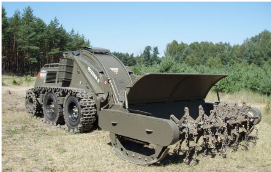
Рис. 11. Гусенична машина для розмінування Bozena-5 Джерело: дані [530].
