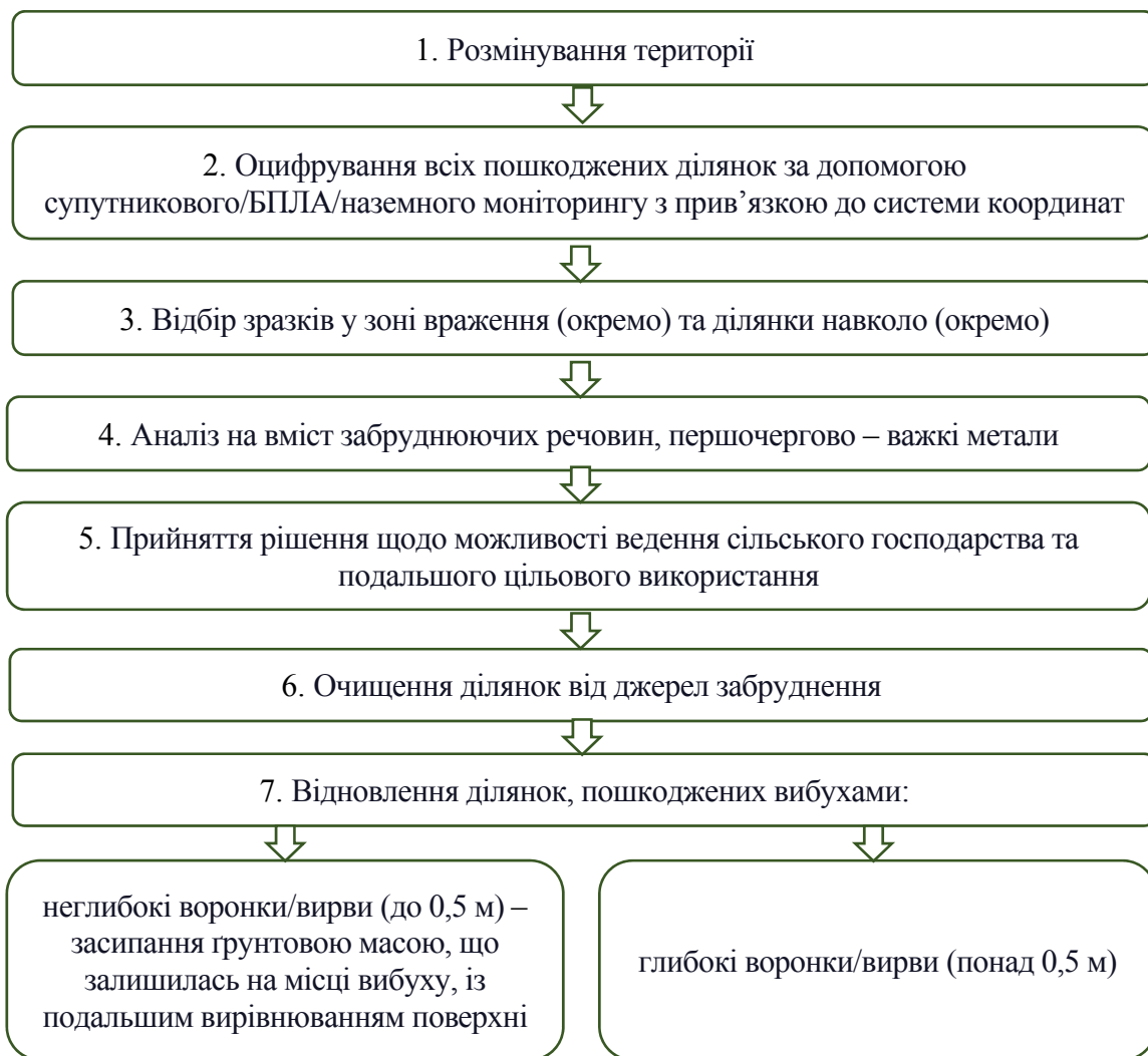
Рис. 12. План дій для ділянок на полях, пошкоджених вибухами, горінням військової техніки
