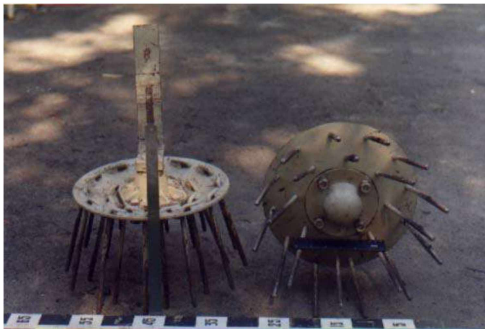
Рисунок 3.13 – дискові голчасто-стрижневі борони, виготовлені в ННЦ ІМЕСГ НААНУ.
