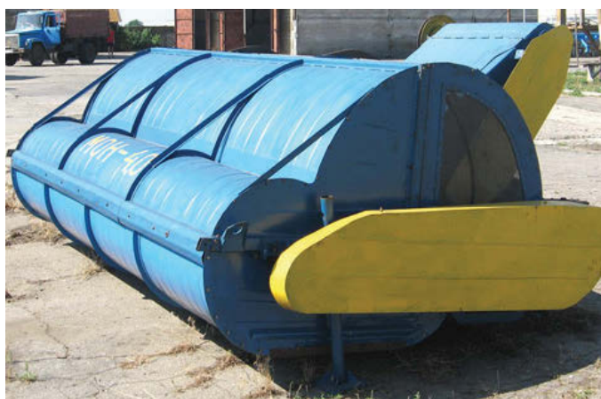
Двобарабанна обчісувальна жатка конструкції ТДАТУ
