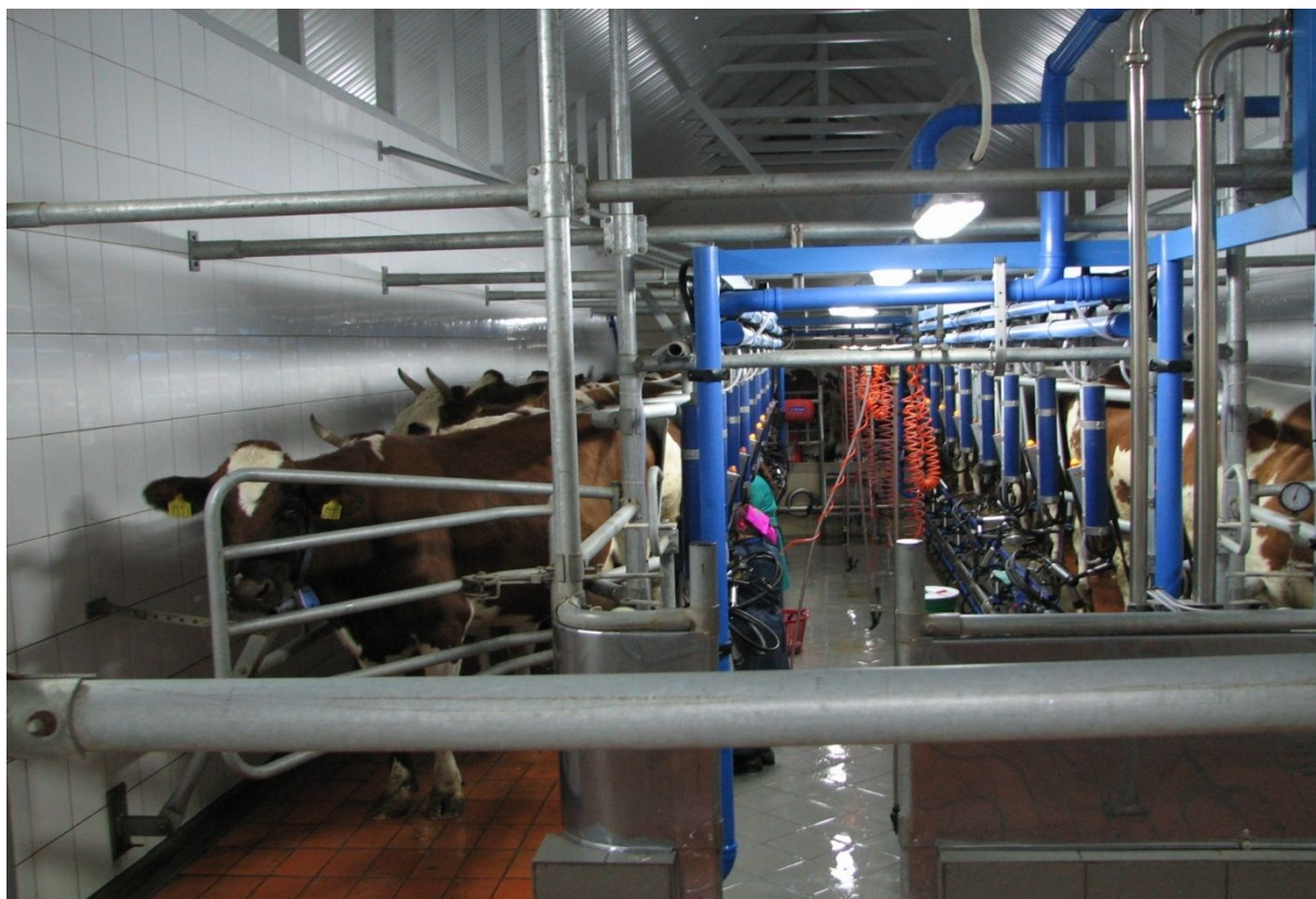
Рис. 3.2. Доїльна установка «Ялинка» 2x8
