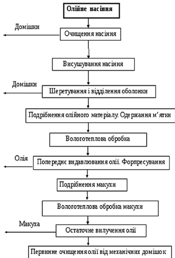
Рисунок 2 – Схема вилучення рослинної олії пресуванням
