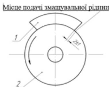
Рис. 8. Схема випробувань: 1 – зразок; 2 – контрзразок
