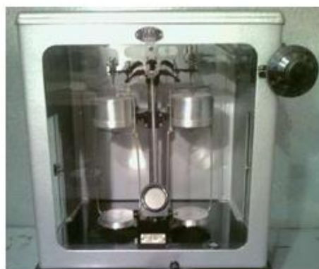
Рис. 7. Аналітичні ваги типу АДВ-200М
