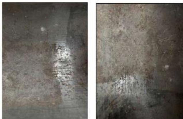
Рис. 1. Фото гідроабразивного та абразивного зношування внутрішньої поверхні гільзи гідроциліндра
