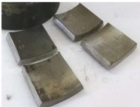
Рис. 3. Заготовки вирізані із стандартних гільз гідроциліндрів і розточених на ремонтний розмір (зразки справа) та вирізані із гільз гідроциліндрів відновлених за технологією термомеханічного зміцнення (зразки зліва)
