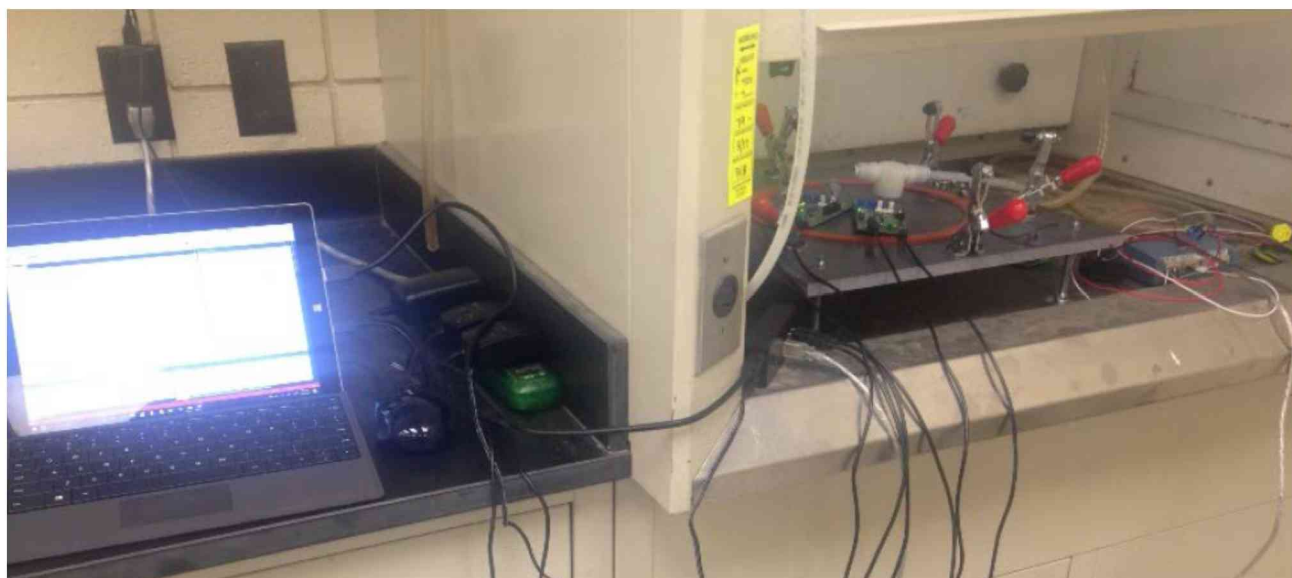
Рисунок 8. Калібровка датчиків у витяжній шафі під час роботи програми на планшетному ПК.
