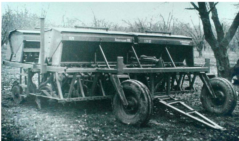
Зернова сівалка для локального внесення добрив за авторським свідоцтвом №1371564 (автори – Гурницький П.В., Ярошенко П.П.)
