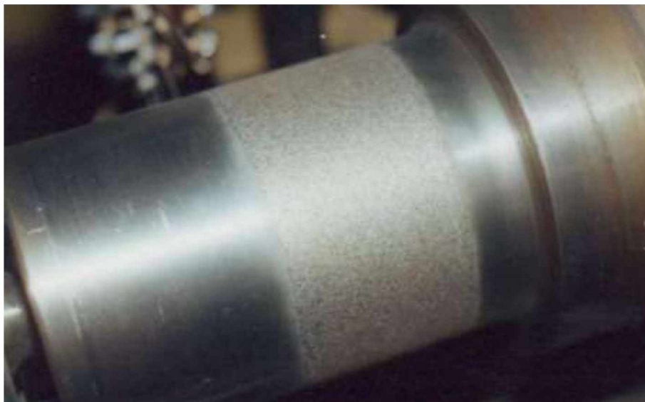
Рисунок 2.3 – Загальний вигляд чавунної ступиці РСМ10.01.45.102Б комбайна Акрос-530, обробленої електроіскровою наплавкою
