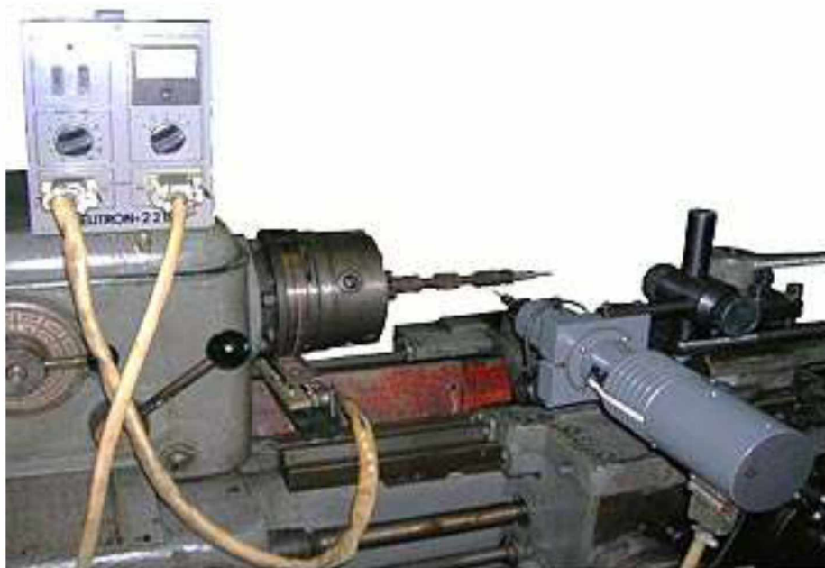
Рисунок 2.2 - Загальний вигляд установки для електроіскрового нанесення відновленого шару
