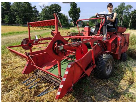
Рис. 1. Селекційний зернозбиральний міні комбайн HEGE, де відсутні шнеки і скребкові елеватори.
