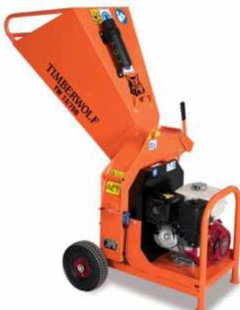
Рисунок 1.3. – Подрібнювач гілок TW 13 / 75G CHIPPER, (професійний клас)
