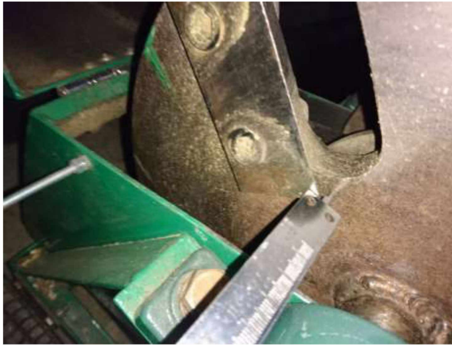
Рисунок 2.6 – Визначення величини виступу ножа від поверхні диску
