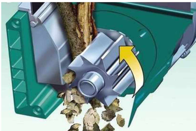
Рисунок 1.3. – Фрезерна різальна система
