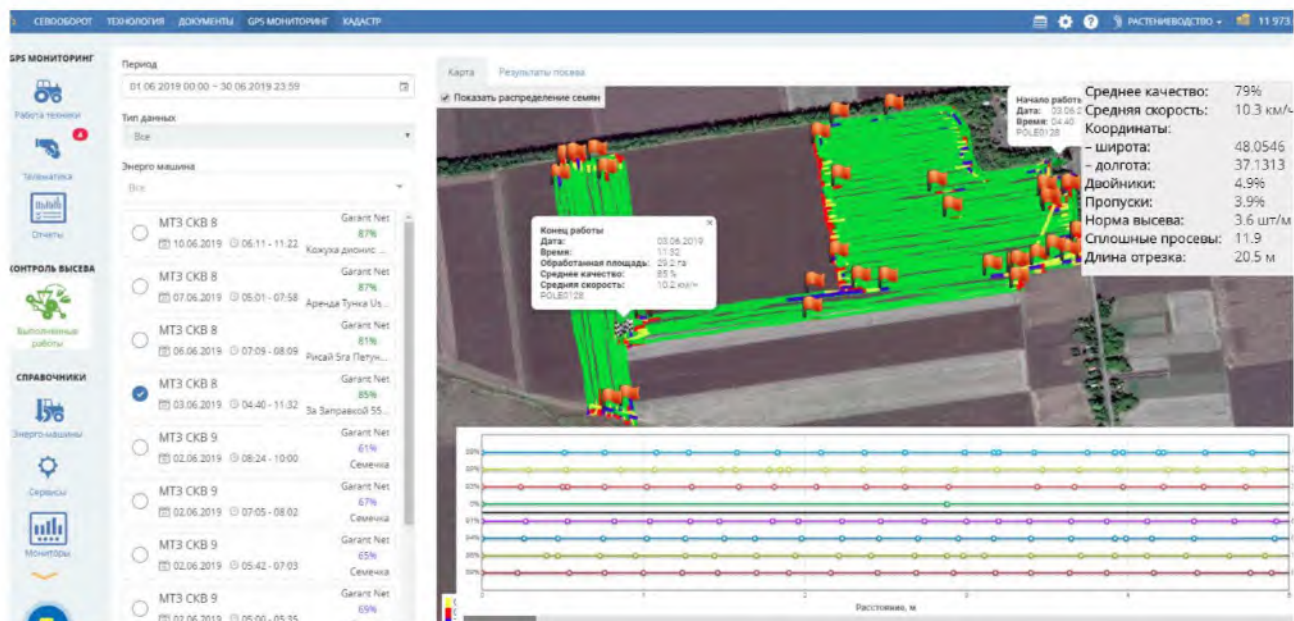
Рисунок 3.12 – Картограма посіву, створена у модулі «Контроль висіву»
