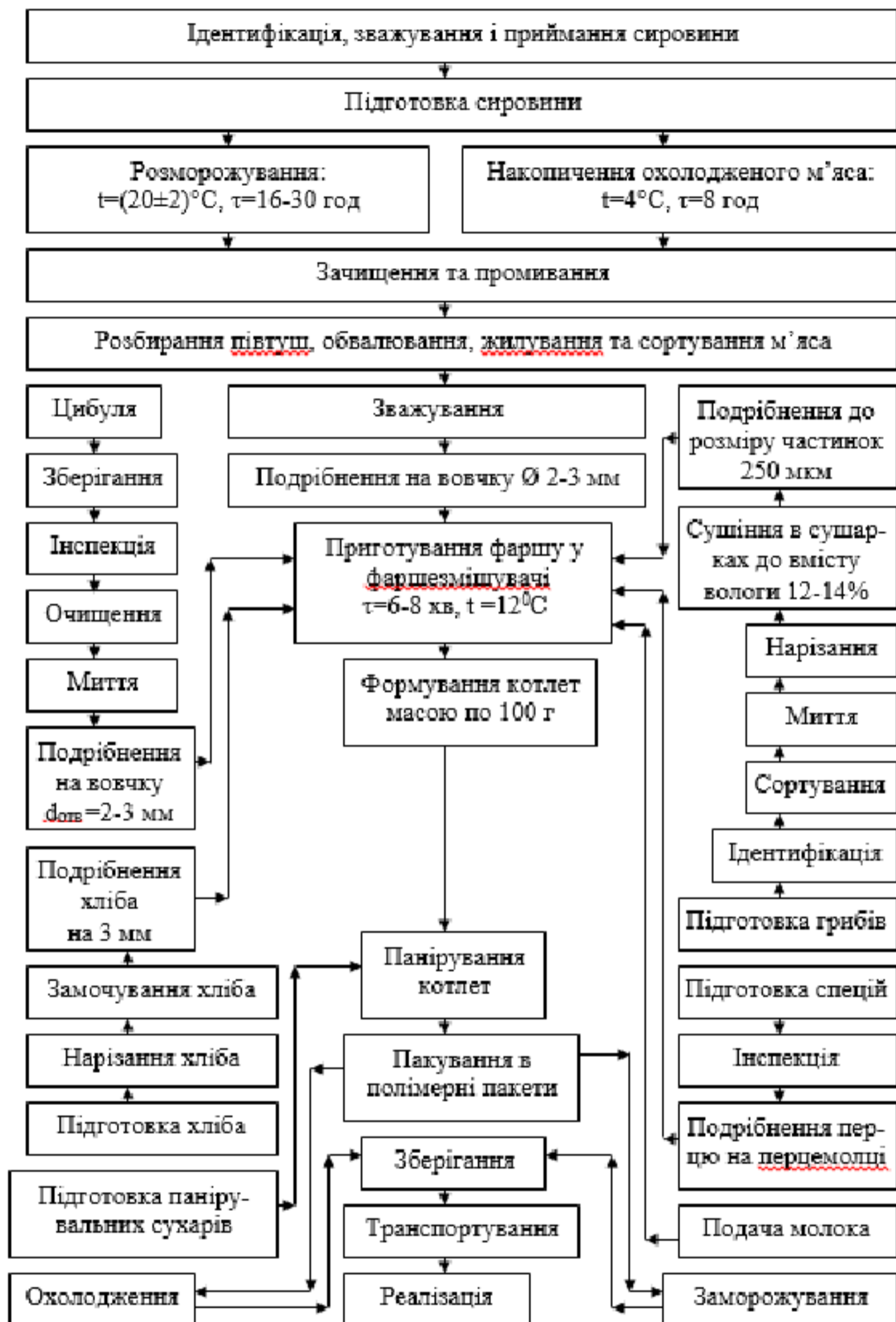
Рис. 1. Технологічна схема виробництва січених напівфабрикатів з грибами
