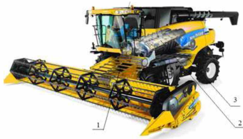
Рисунок 1.2 - Приклад технічного виконання двобароторної молотарки: 1 – транспортер похилті камери, 2 – двороторний молотильно-сепарувальний пристрій, 3 – очистка комбайна.
