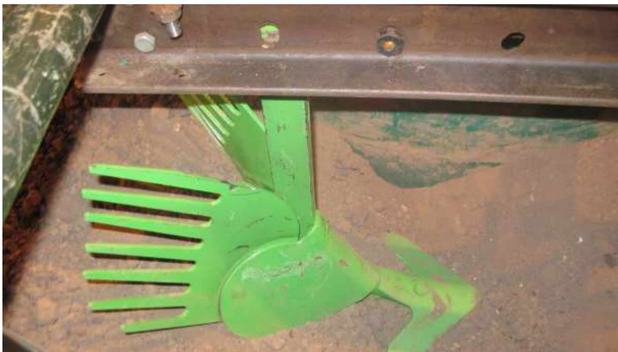
Рисунок 2.2 – Робочий орган для рядкового пригортання картоплі.
