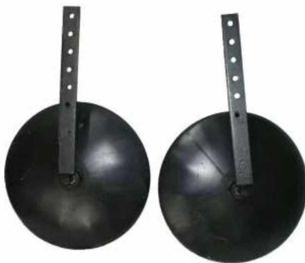
Рисунок 1.3. – Фото начіпного обладнання мотоблока – дисковий підгортач
