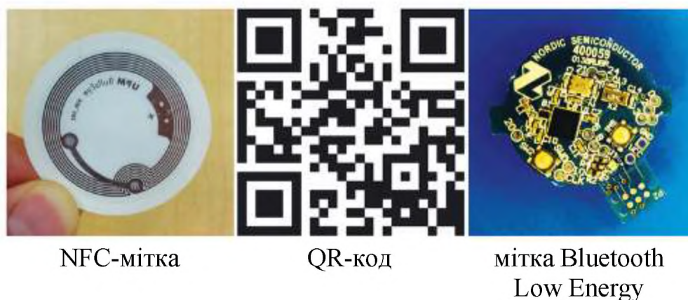
Рисунок 1.3 – Різні види електронних міток, які підходять для фізичної павутини
