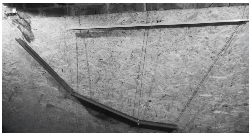
Рис. 1. Гравітаційна установка щодо дослідження контрольованого руху зерна на розгінному і двох гальмівних ділянках прямого каналу
