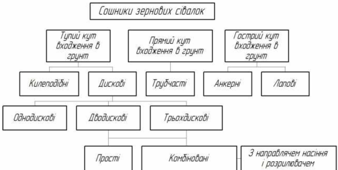
Рисунок 1.4 – Класифікація сошників зернових сівалок
