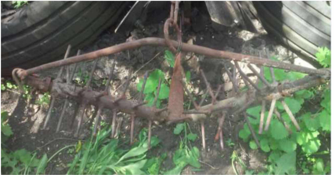
Рисунок 3.3 – експериментальна дискова голчаста борінка для виконання операційної технології післяпосадкового боронування картопляних гребенів.
