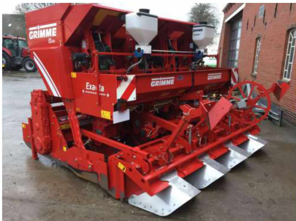
Рисунок 1.4 – Загальний вид картоплесаджалки фірми «Grimme», що призначена для одночасного садіння 4-х рядків бульб.
