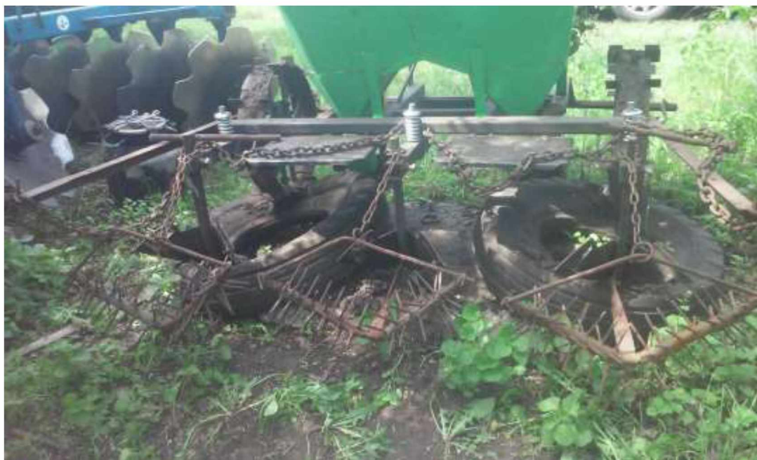
Рисунок 1.5 – Експериментальні голчасті роторні борінки, що розглядаються як об'єкт дослідження та удосконалення за темою магістерської роботи.
