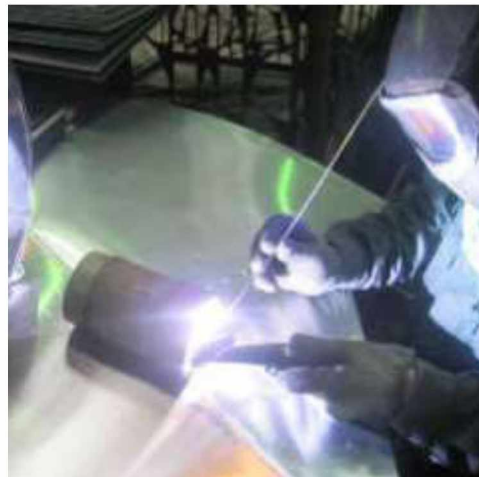
Рисунок 2.2 – Технологія наплавлення канавок міддю М1 металізованої гільзи циліндрів
