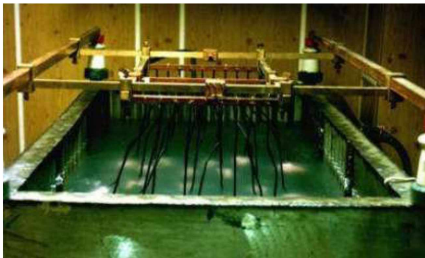
Рисунок 2.5 – Установка мікродугового оксидування деталей
