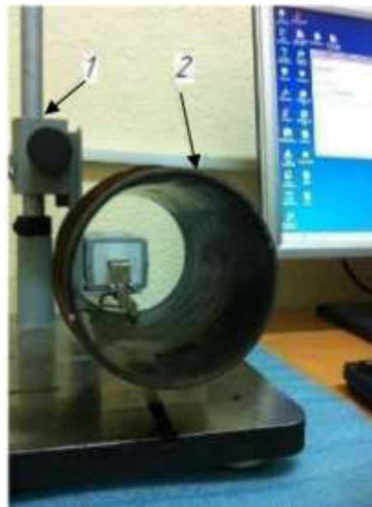
1 – профілограф-профілометр модель 130, 2 – досліджувана гільза Рисунок 2.7 – Загальний вигляд установки визначення шорсткості
