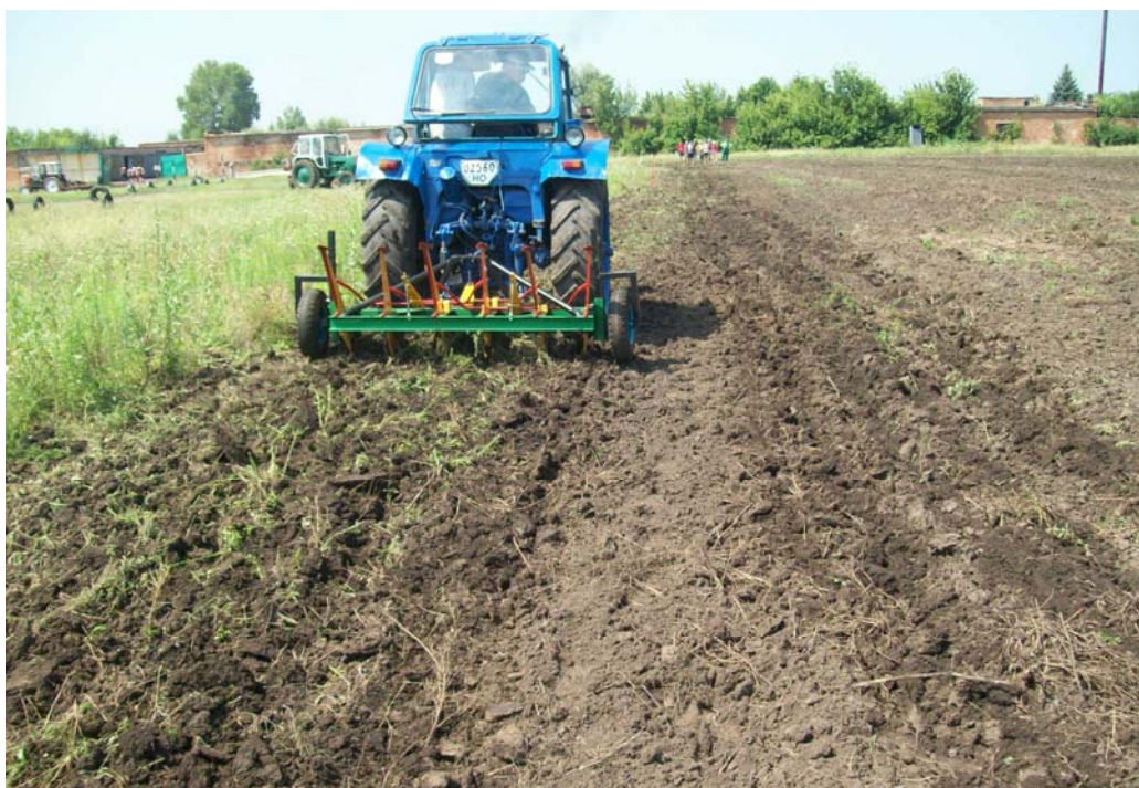
Рис. 1. Робота запропонованого ґрунтообробного агрегату по парі
