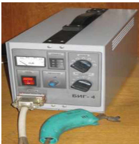
Рисунок 2.3 – Установка для електроіскрового відновлення БІГ- 4 [11].
