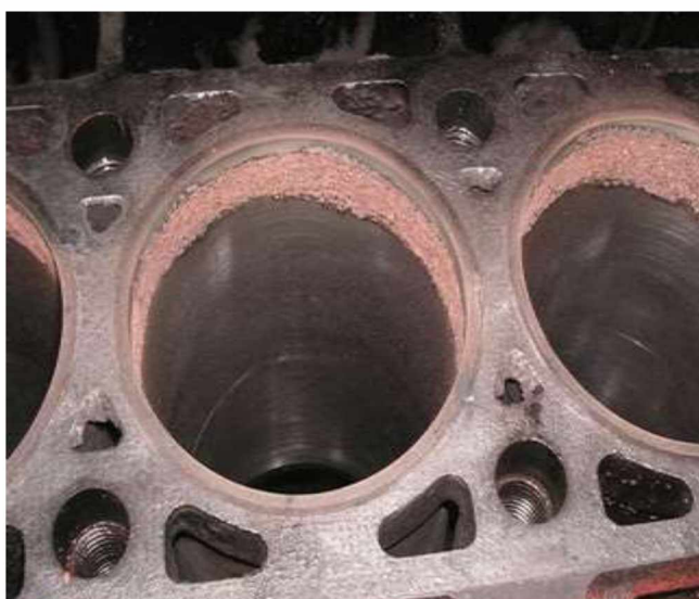
Рисунок 1.13 -Гільзи циліндрів двигуна САТ-3116 після відновлення методом електроіскрового нарощування (без механічної обробки) [10]
