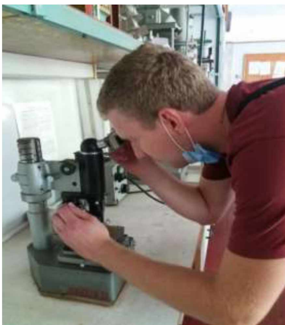
Рисунок 2.5– Вимірювання мікротвердості на мікротвердомірі ПМТ -3:
