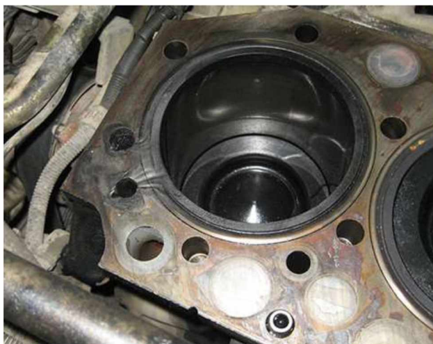
Дефекти на площині роз'єму головки і блоку циліндрів
