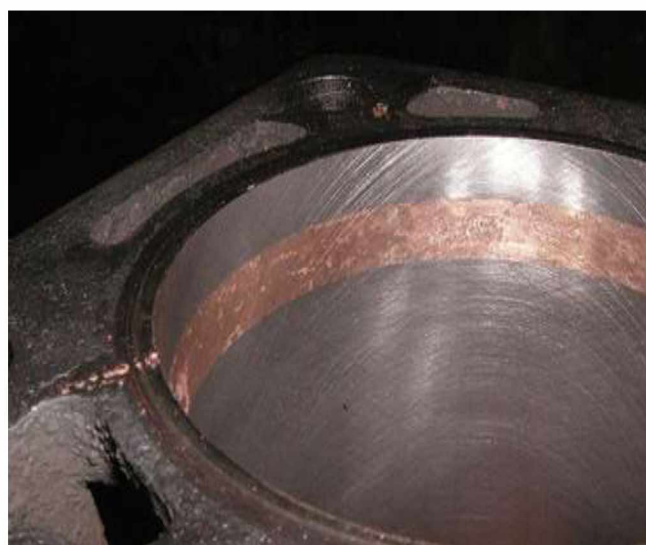
Рисунок 1. 14 – Відновлення глибокої подряпини гільзи двигуна САТ-3116 методом електроіскрового легування (після механічної обробки)
