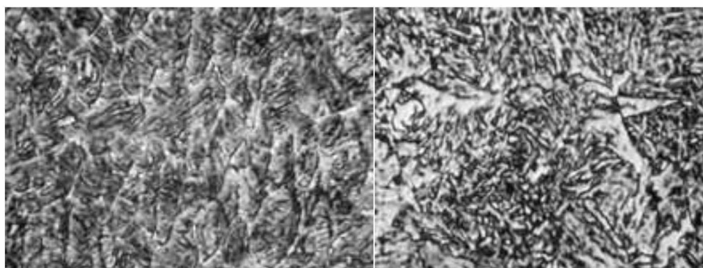
Рисунок 3.8 - Поверхневий шар зразків оброблених електродом із сплаву 150X30: а - 1 прохід електроду; б - 3 проходи електроду.
