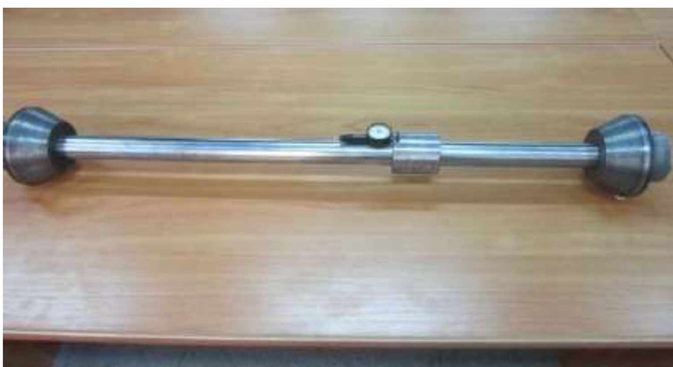
Рисунок 2.2 – Пристосування для вимірювання співвісності ліжок блоку циліндрів двигуна
