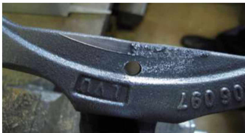
Рисунок 1.15 - Відновлена ділянка чавунної вилки переключення передач коробки зміни передач [10]
