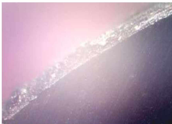
Рисунок 3.7 - Фото зміцненого шару чавунного зразка електроіскровим методом (x100 )
