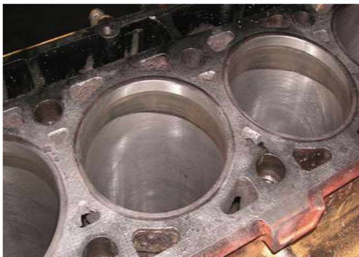
Зношені гільзи циліндрів двигуна CAT-3116
