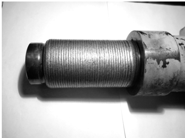
Рисунок 2 – Внешнее формирование износостойкого покрытия порошкообразным присадочным материалом при его подаче в столб сжатой дуги под действием сил тяжести частиц
