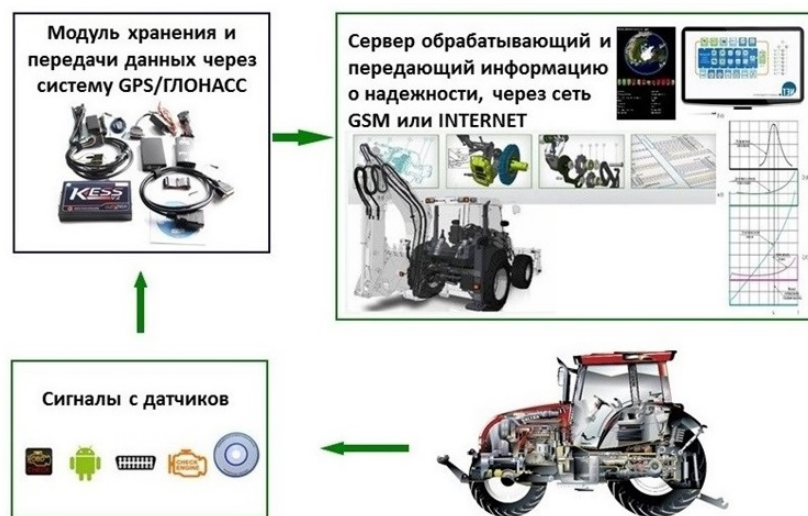
Рисунок 11 - Блок-схема системы мониторинга состояния узлов трактора
