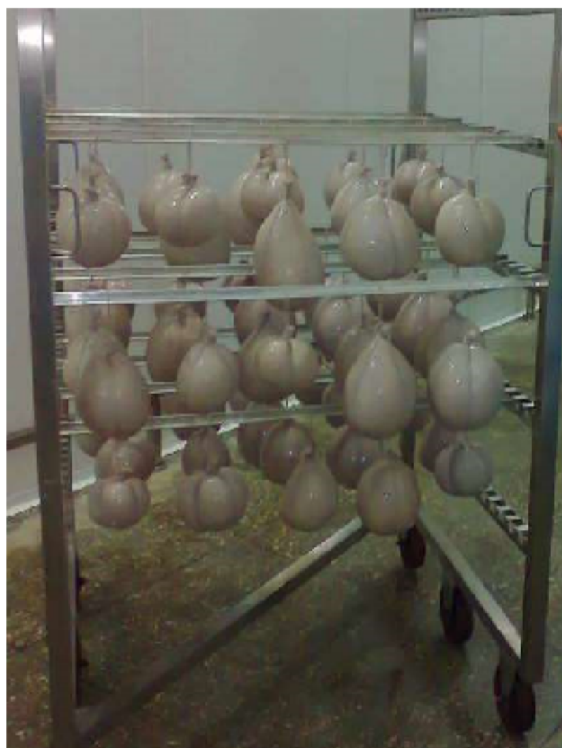
Рис. 2.6. Процес осаджування ковбасних батонів
